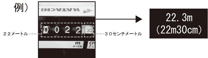
⑤測定した距離をリセットするときは、表示板の左にあるレバーを押します。
