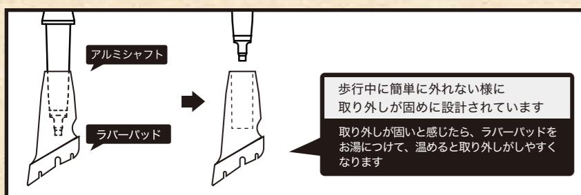
アルミシャフト先端のラバーパッドを取り外す時は、強く引き抜いてください
