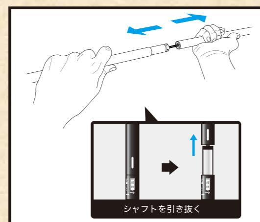
ロックが解除された状態で、シャフトを引き抜きます
